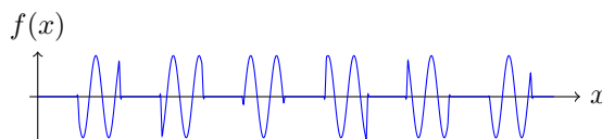
Figura 4.4: Esquema de onda modulada en amplitud al 100 %
