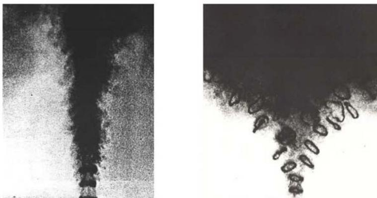
**Figura 4.** Control de un chorro turbulento. A la izquierda se presenta un chorro natural, mientras que a la derecha, el mismo chorro ha sido sometido a perturbaciones, menores del 1%, en resonancia con su modo más inestable (Lee & Reynolds 1985).
