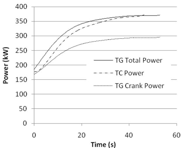
Figure 17. POWER OUTPUT AGAINST TIME DURING THE ENGINE SPEED TRANSIENT
