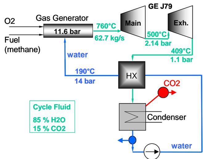
**Fig. 3:** Flow configuration of J79 testing at KPP (CES-J79)
