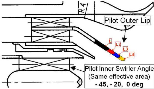
Figure 2 Design parameters
